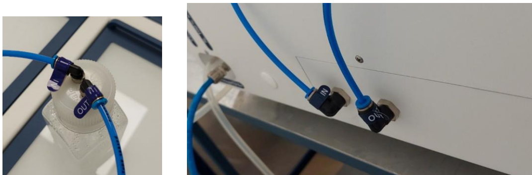
Figure 23.1 Tube de raccordement sur la bouteille d'humidification et l'incubateur MIRI® Humidity multiroom FIV
