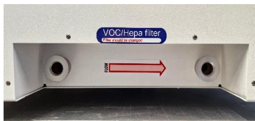
Figure 12.1 La flèche d'écoulement sur l'incubateur FIV à compartiments MIRI®
