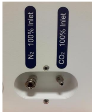
Figure 11.1 Entrées de gaz à l'arrière de incubateurs FIV à compartiments MIRI® et MIRI® Humidity
